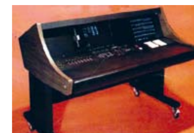
Strand Light Palette, il nuovo sistema a microprocessore introdotto nel 1979, permetteva di registrare e richiamare liste di cues partizate e temporizzate le transizioni. Poteva gestire un massimo di ben 500 canali e 8 submaster.
