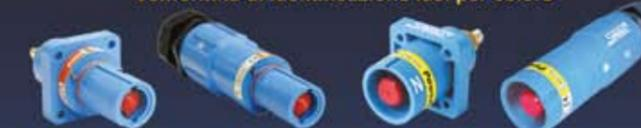
SPT nuova serie (Veam compatibile) IP68 connettore maschio (drain) protetto inserzione-estrazione rapida contatto predisposizione serracavi metrici M40 per cavi da Ø 15 mm a Ø 32 mm
