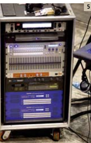
4: Il rack contenente i processori Galileo ed i convertitori AD Apogee AD-16X.
