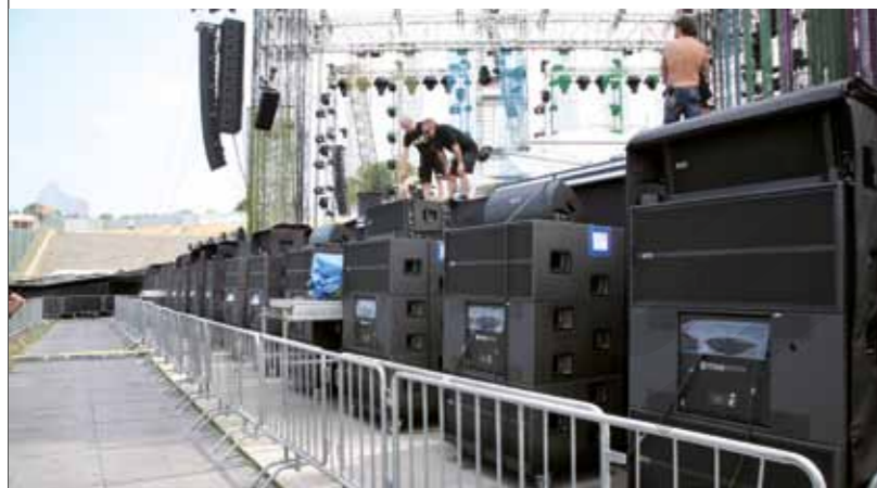
La configurazione dei sub a terra a fronte palco.
