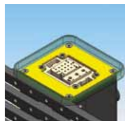
Dettagli dei sistemi di interconnessione tra i pannelli del Mirage QC.
